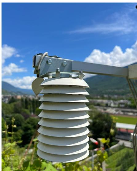
Sensore digitale di temperatura ed umidità dell'aria, con schermo solare. Calcolo del punto di rugiada.
