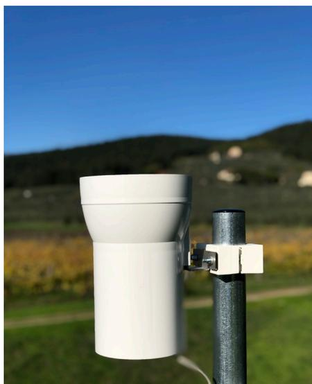
Pluviometro RainSense con accessori di installazione.
