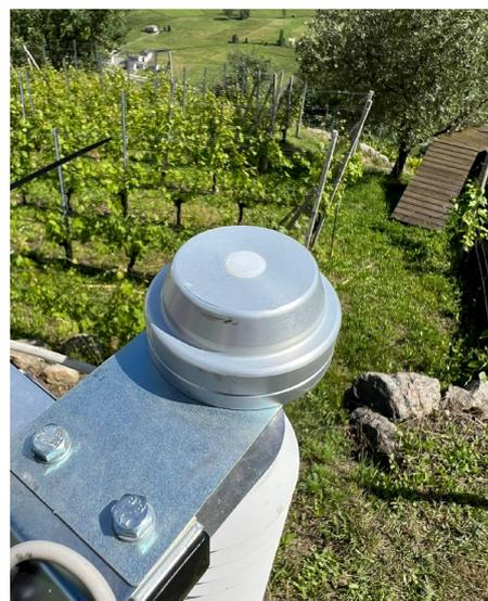
Sensore di radiazione solare con staffa di montaggio a paleria orizzontale.
